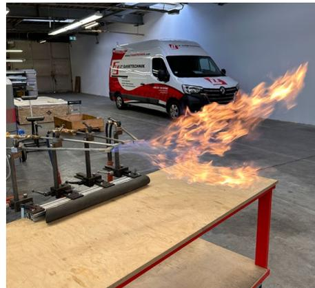
Flammen eines Brenngasmischers aus Methan/O<sub>2</sub>
