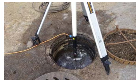
Pegelmessung an der Rohrleitung einer Siloanlage:
