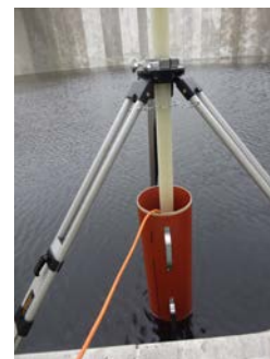
Pegelmessung an der Rohrleitung einer Siloanlage:
