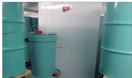
Datenlogger registrieren die Temperaturverläufe im Kühlraum
